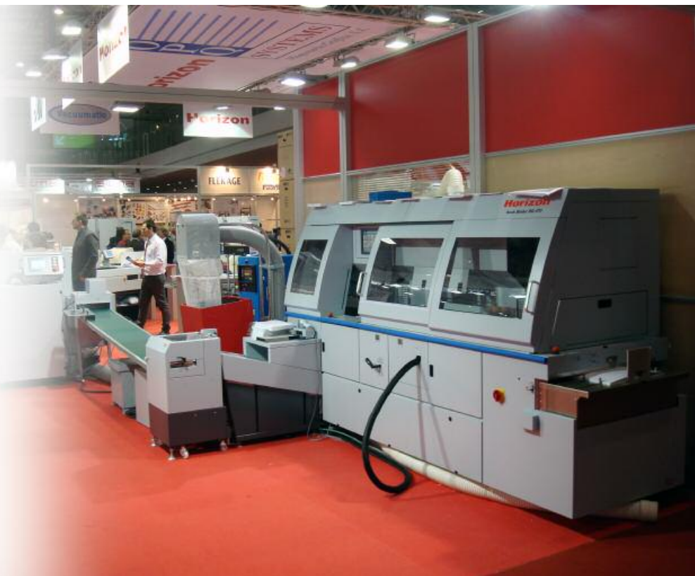
El sistema BQ-470CFC encuaderna hasta 1.250 libros por hora y trabaja junto con la guillotina HT-80. Foto: OPQ Systems.
