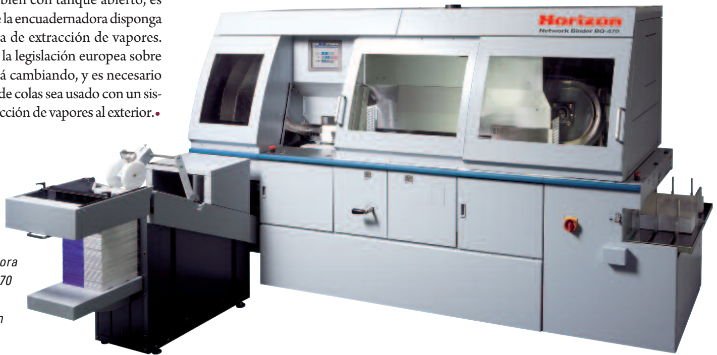
Unidad de recogida de los libros acabados de encuadernar en la Horizon BQ-470.
