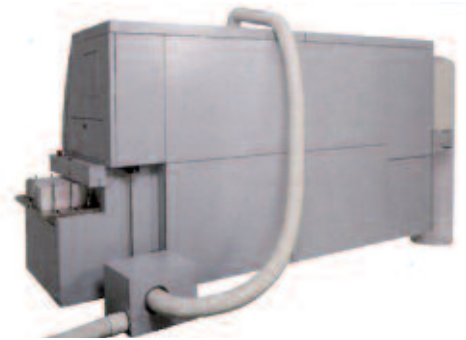
Vista posterior de la Horizon BQ-470 con el sistema de extracción de vapores.
