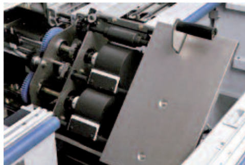
Tanque de cola PUR Horizon en auto limpieza.
